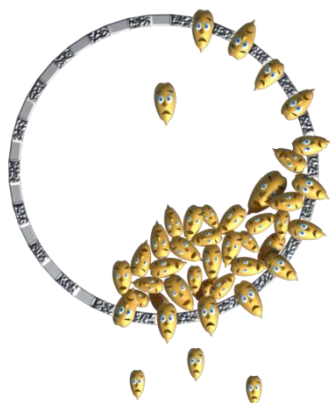
Рис. 14. Схема взаимодействия зерна с горизонтальным перфорированным барабаном.
